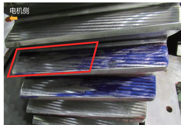
负载运行状态下的齿轮啮合
