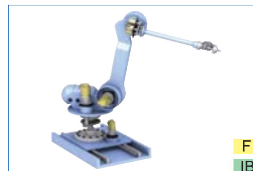
工业用机械手 各轴驱动、机械手滑动件
